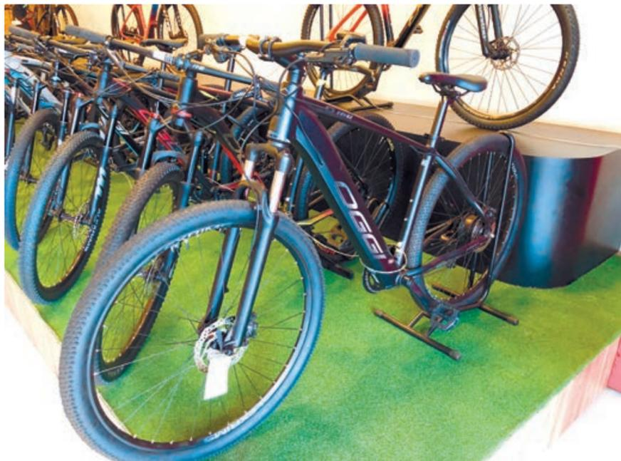
Na foto uma bicicleta de pedal assistido, cujo motor ativa o modo de propulsão conforme o ritmo das pedaladas cai, fornecendo um impulso adicional
